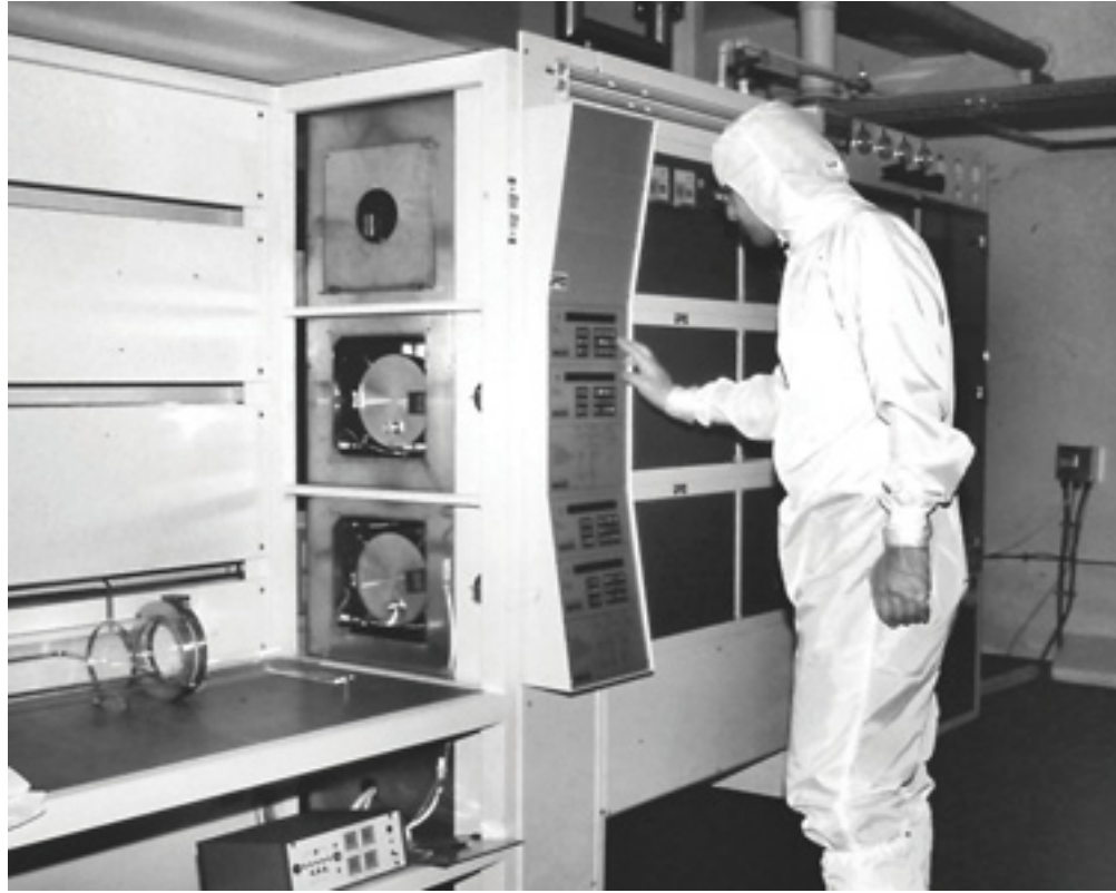
Silisyum nitrit ve polisilyum depolama (LPCVD) cihazı.
